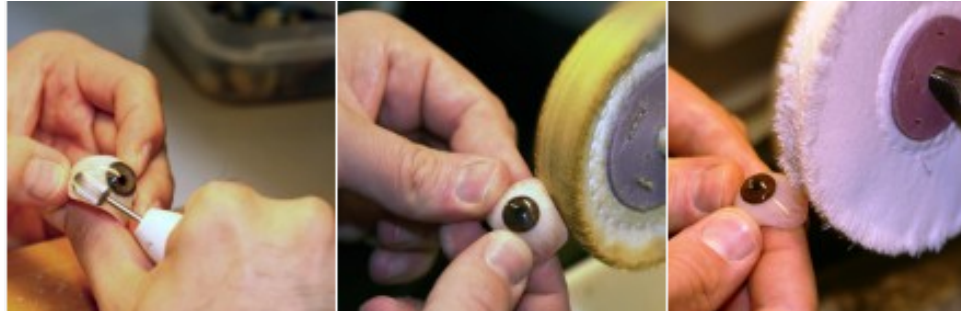
Ilustración 13 Pulido y acabado de la prótesis ocular
