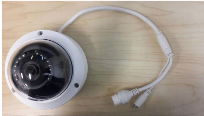
Figura 39 cámara IP, Fuente Autor
