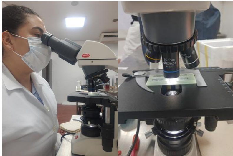
Figura 4 Observación de microalgas y conteo en Cámara Neubauer.
